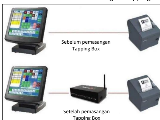
Gambar 4-2 Instalasi Perangkat Tapping Box
