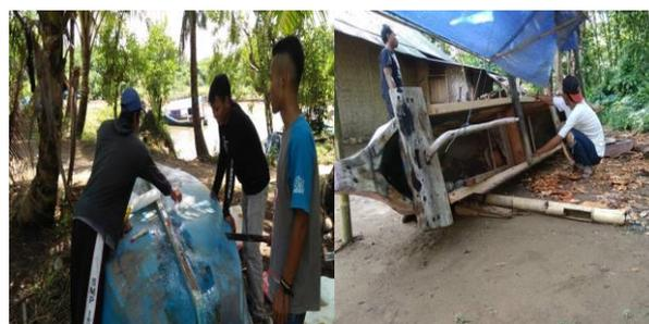
**Gambar 6.** Proses Perbaikan Perahu Nelayan
