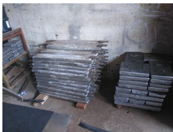
Gambar 2. Beberapa Contoh Barang Setengah Jadi Zinc Anode Berbagai Ukuran
