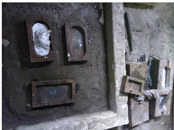
Gambar 1. Beberapa Contoh Cetakan Zinc Anode
