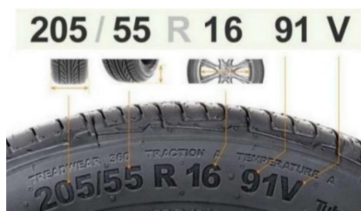
Gambar 2. Load Index pada Ban
